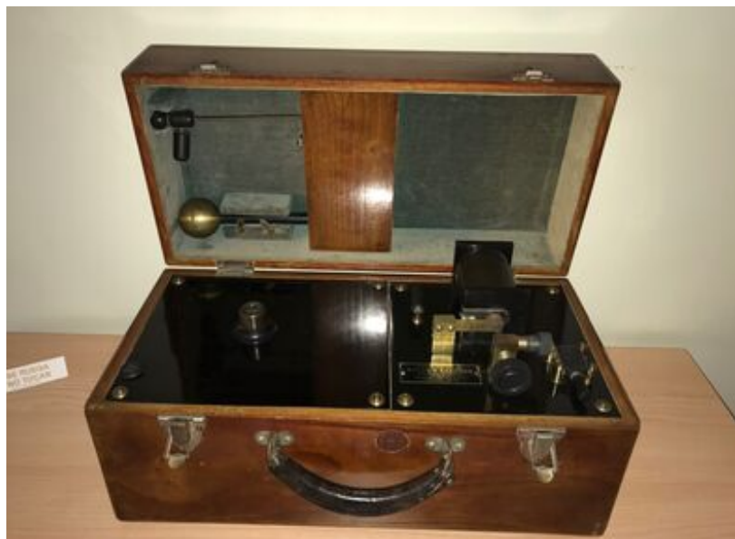
Aparato Portátil de Rayos X Sánchez (1911) Estación Experimental de Zonas Áridas (EEZA/CSIC)
